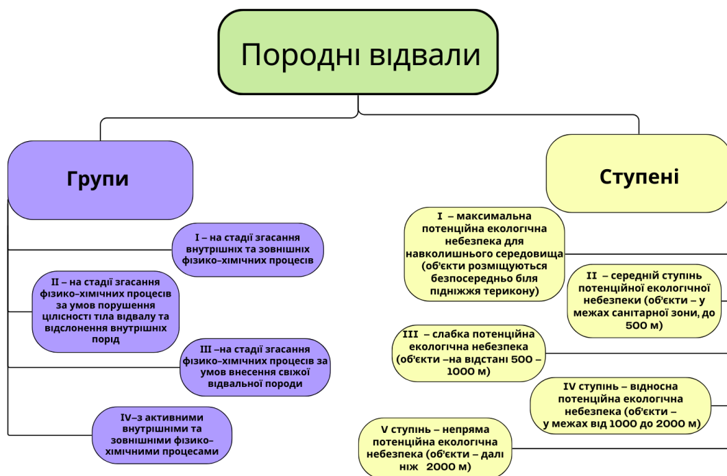
Рис. 1.2 – Загальна схема класифікації породних відвалів (укладено за [9])
