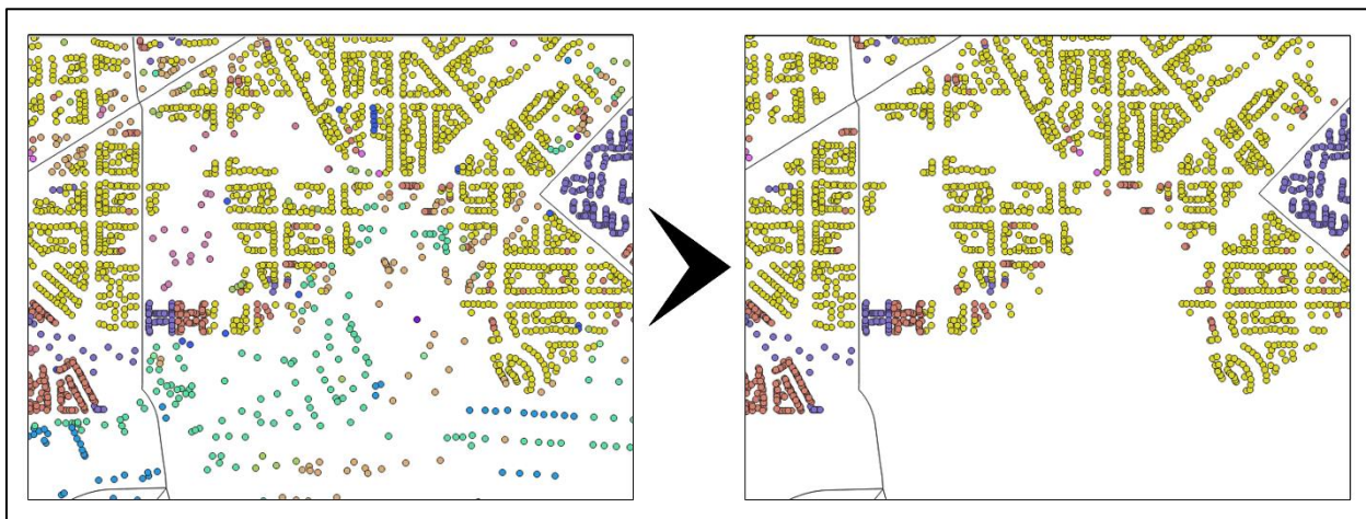
Рис.3.17. Фільтрація центроїдів житлових будівель.
