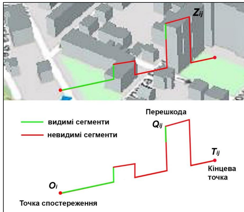
Рис.3.48. Компоненти лінії видимості [20].
