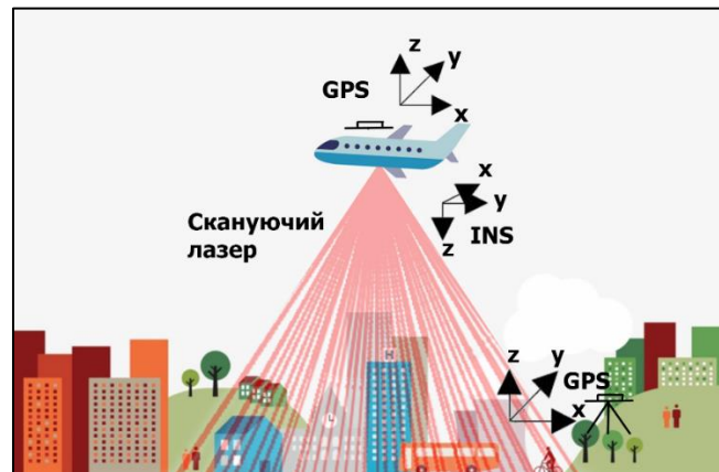
Рис. 1.11. Компоненти апаратного забезпечення лідара (побудовано автором за [184].
