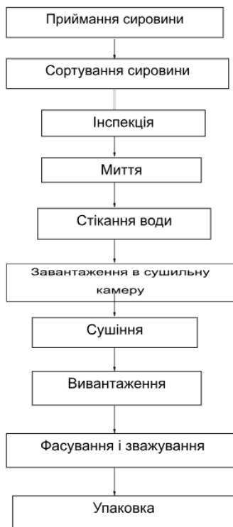
Рис. 5.2. Низькотемпературне сушіння ягід чорноплідної горобини
