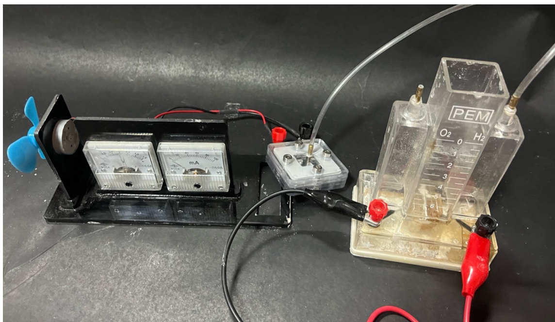
Рис. 6.9. Повний цикл перетворення води у водень та отримання електроенергії з іншим електролізером.
