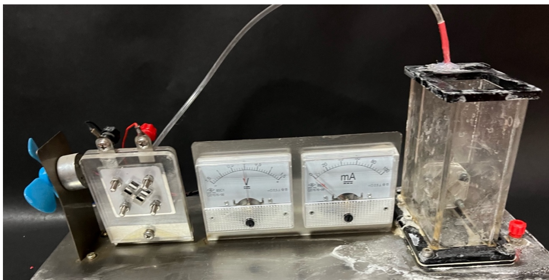
Рис. 6.8. Повний цикл: перетворення води у водень із подальшим отриманням електроенергії (експериментальна установка).
