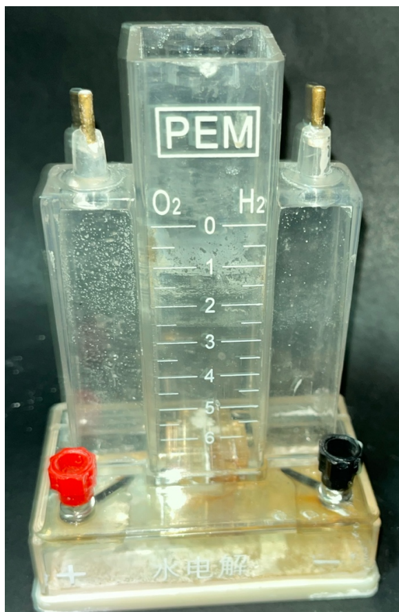
Рис. 6.3. Компактний електролізер для розкладання води на водень і кисень.
