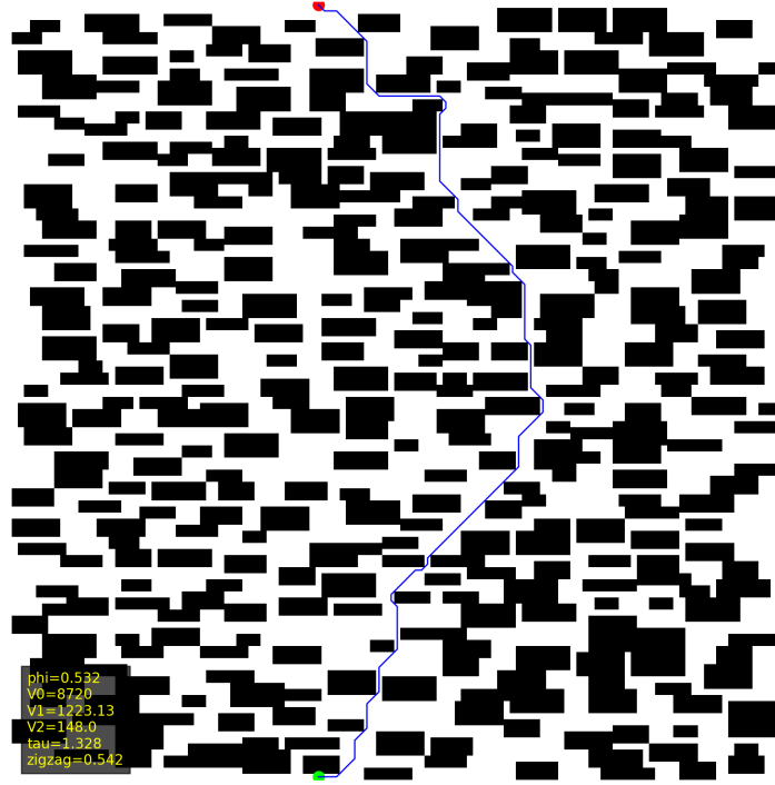
Рис. 1: Приклад згенерованого пористого середовища для Моделі 1 (випадкові прямокутники з перекриванням) із позначеним найкоротшим шляхом.
