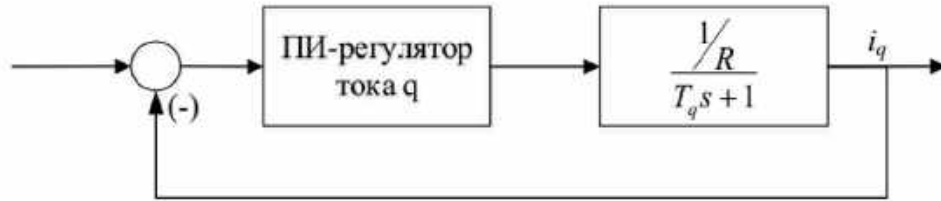
Рисунок 30 – Структурна схема контуру струму в режимі загальмованого двигуна
