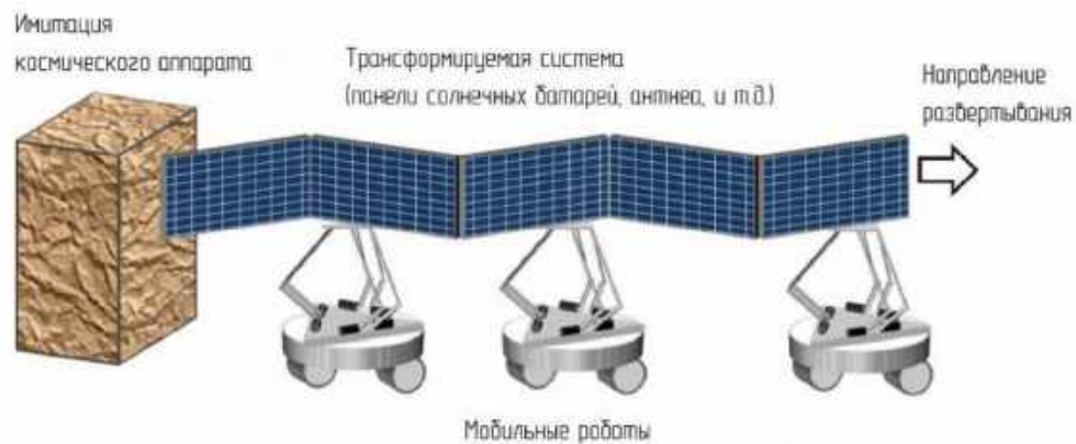
Рисунок 8 - Структура системи зневажування з мобільними роботами
