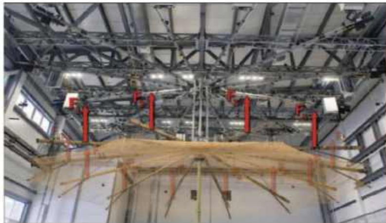
Рисунок 3 - Система зневажування трансформованих систем космічних апаратів «Кемчуг»
