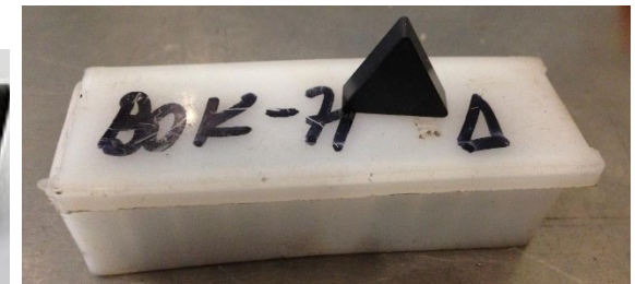
Змінні ріжучі пластини з кераміки марки ВОК 71
