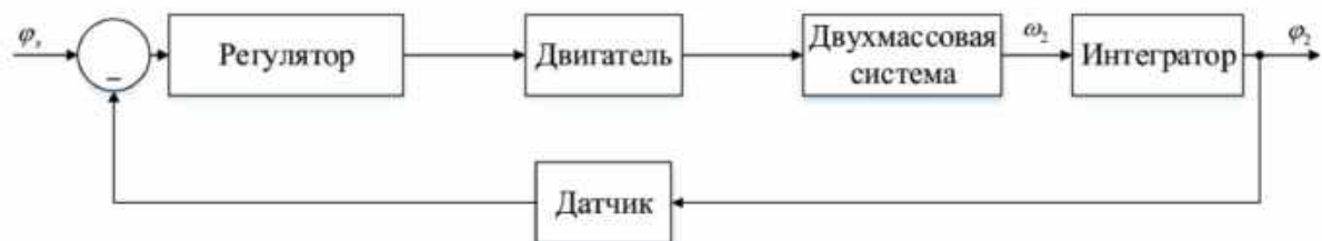
Рисунок 24 – Функціональна схема системи керування положенням робочого органу бурильної колони
