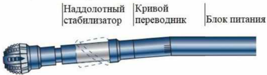
Рисунок 3 – Загальний вигляд КНБК
