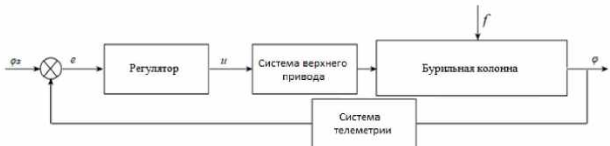
Рисунок 8 – Функціональна схема системи управління бурильної колони
