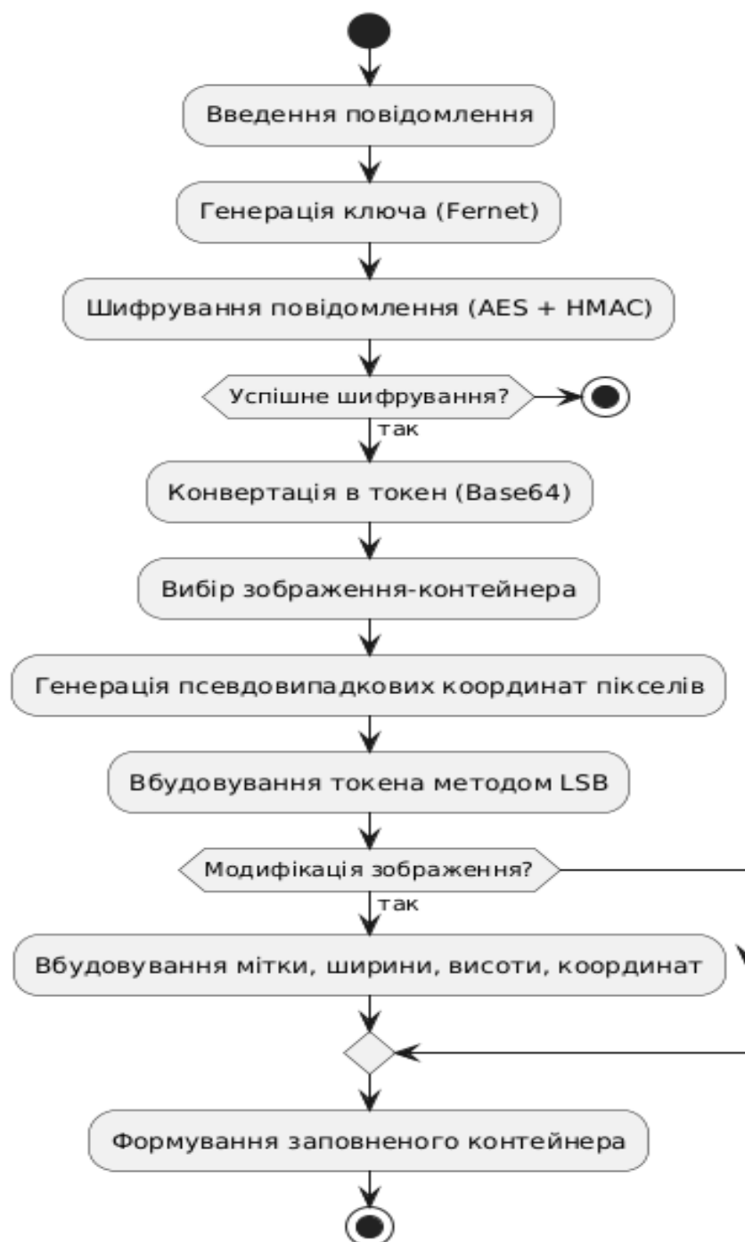
Рисунок 3.1 - Функціональна схема роботи застосунку зі шифруванням та стеганографією
