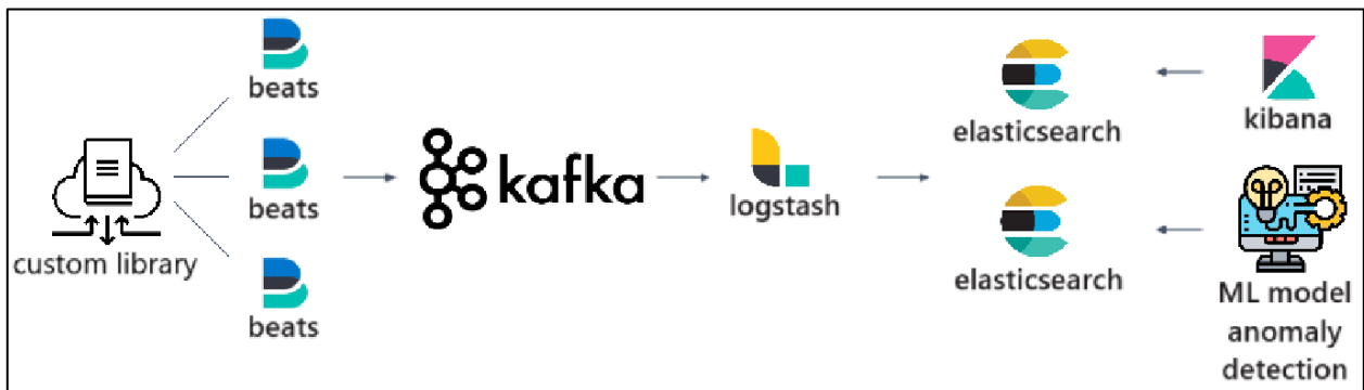
Рисунок 3.2.1 - Скріншот архітектури лог-пайплайну на базі Kafka, Beats, Logstash, Elasticsearch та Kibana, загальна схема
