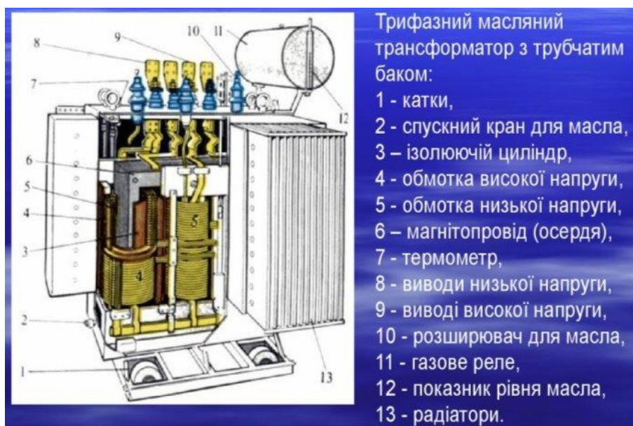
Рис. 7.1. Силовий трифазний трансформатор
