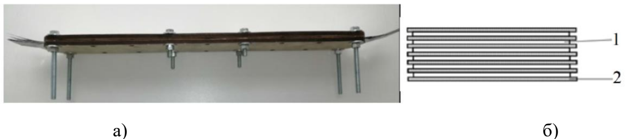
Рисунок 2.13 – Макет плоского багатошарового провідника: а) фотографія зразка; б) схема конструкції провідника: 1 – алюмінієвий провідник, 2 – феромагнітний шар
