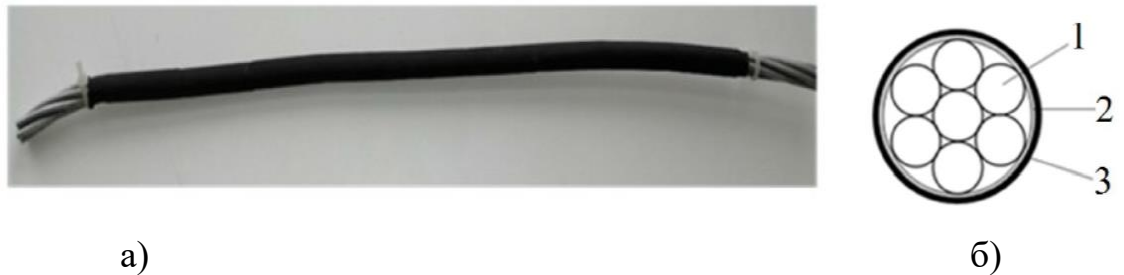
Рисунок 2.12 – Макет круглого провідника: а) фотографія зразка; б) схема конструкції провідника: 1 – алюмінієвий провідник, 2 – феромагнітний шар, 3 – діелектричний захисний шар
