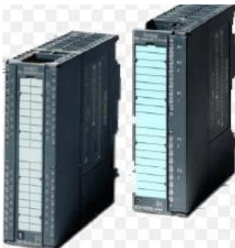
Рисунок 4 – Модулі дискретного введення/виводу SM 321/SM 322 Властивості SM 321, DI 8 x AC 120/230 V:
