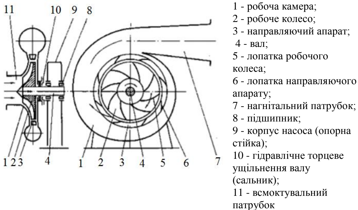
Рис. 3.3. Схема відцентрового насоса
