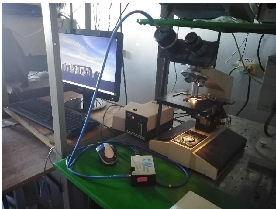
Рисунок 2.1 – Мікроспектрометр USB4000, з'єднаний оптоволоконним дротом з оптичним мікроскопом та комп'ютером
