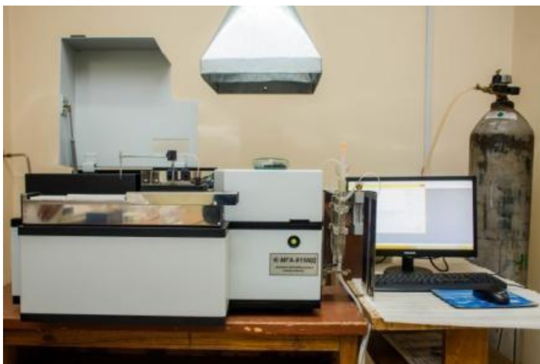
Рис. 2.3 – Атомно – абсорбційний спектрометр «МГА – 915 МД»
