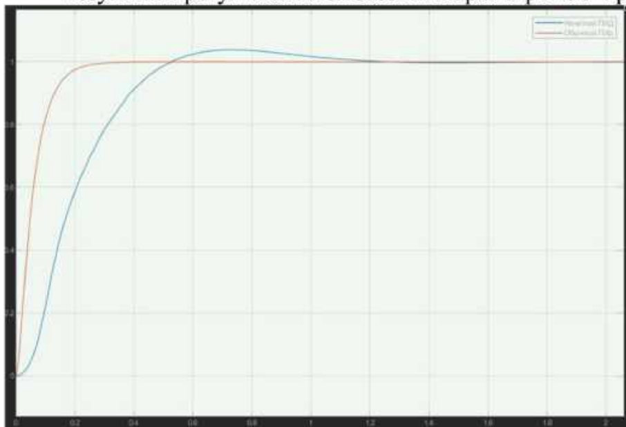
Рисунок 42 - Результати ПД-регулювання при базовій передавальній функції
