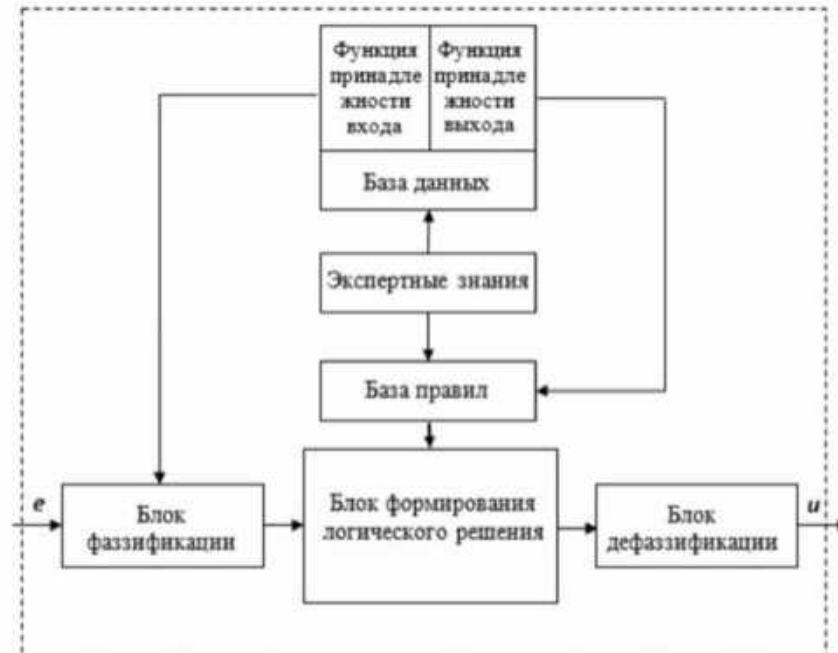
Рисунок 11 – Структурна схема нечіткого регулятора
