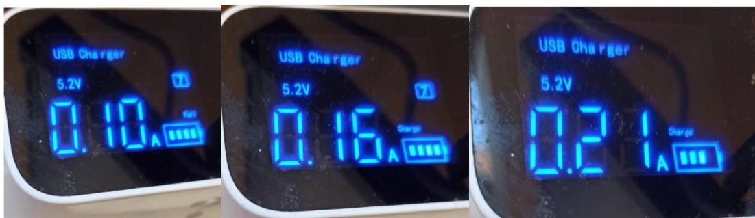
Рисунок 3.4 – Arduino UNO без навантаження, з одним світлодіодом та с двома світлодіодами
