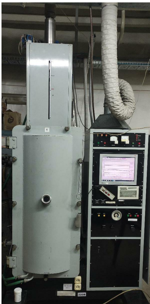
Рисунок 2.1. Установка для вирощування монокристалів “Оксид-1”.
