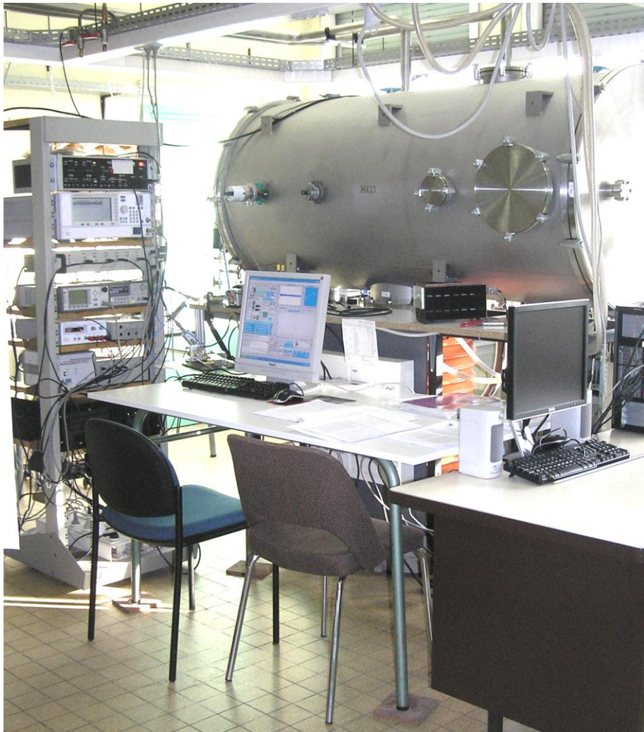
Рис.1. Зовнішній вигляд емісійного спектрометра з перетворенням Фур'є в Лільському університеті
