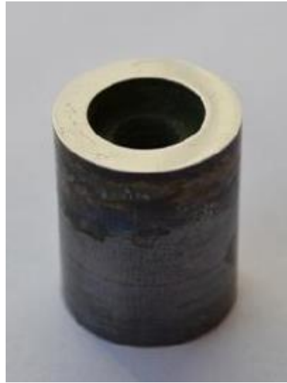
Рисунок 3.5 – Експериментальний сталевий кільцевий зразок з полірованим торцем
