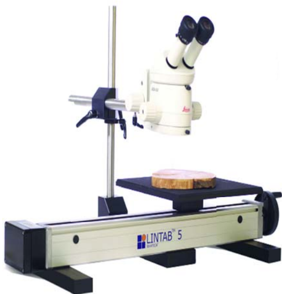
Рис. 2.5 Прилад Lintab для вимірювання шарів деревини
