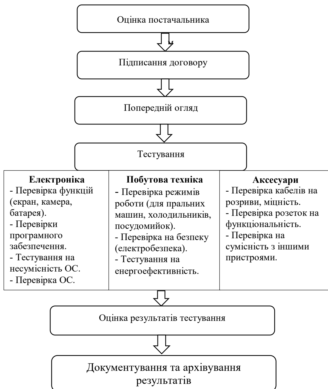
Рис. 3.1. Алгоритм перевірки якості продукції для ФОП «МУРАТОВ»
