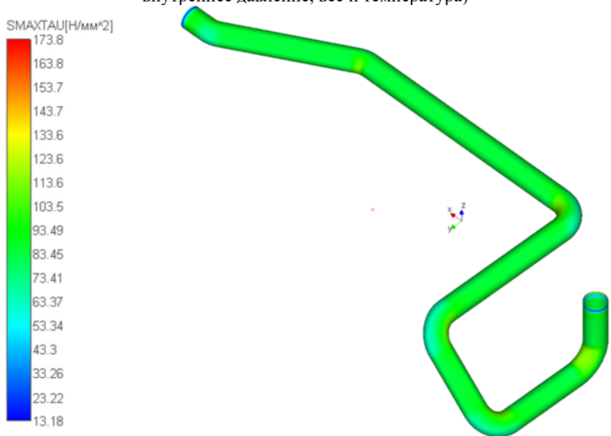
Рис. 2.39. Розподіл наведених напруг \sigma_{13} в трубопроводі зв'язку КО з «гарячої» ниткою петлі №4 ГЦК. (Режим НЕ + МРЗ, навантаження - внутрішній тиск)
