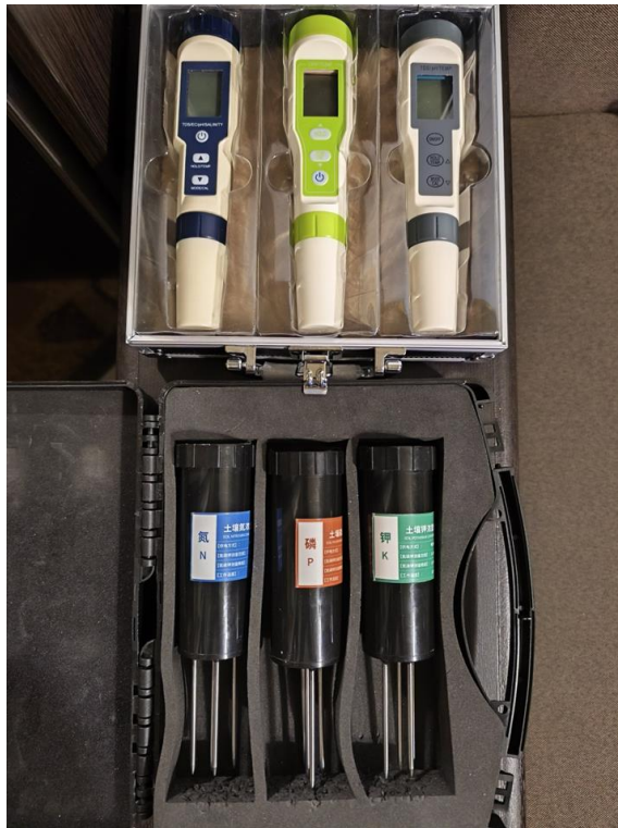
Рис. 2.2 – Кондуктометри для визначення фізико-хімічних показників живильного розчину в гідропонних системах
