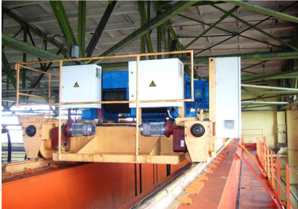
Рисунок 1.4 - Візок вантажопідйомністю 200т. ВАТ «Турбоатом»
