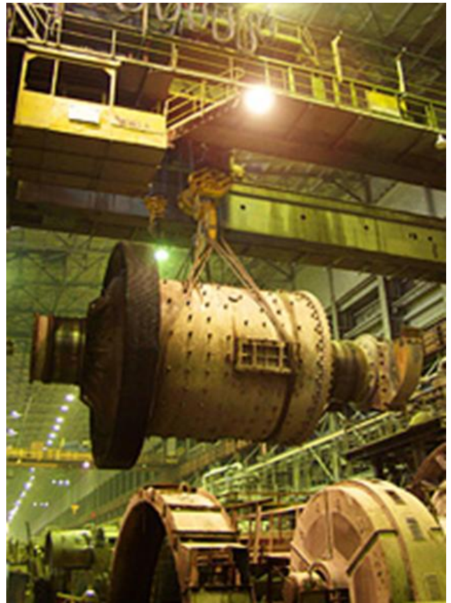
Рисунок 1.3 - Мостовий спеціальний кран вантажопідйомністю 200 тон. АТ «Українські енергетичні машини»
