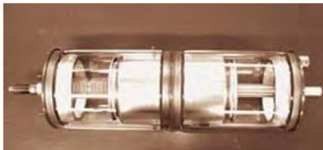
Рисунок 3.1 - Вакуумна дугогасна камера на 145 кВ японської компанії AE Power System Corporation
