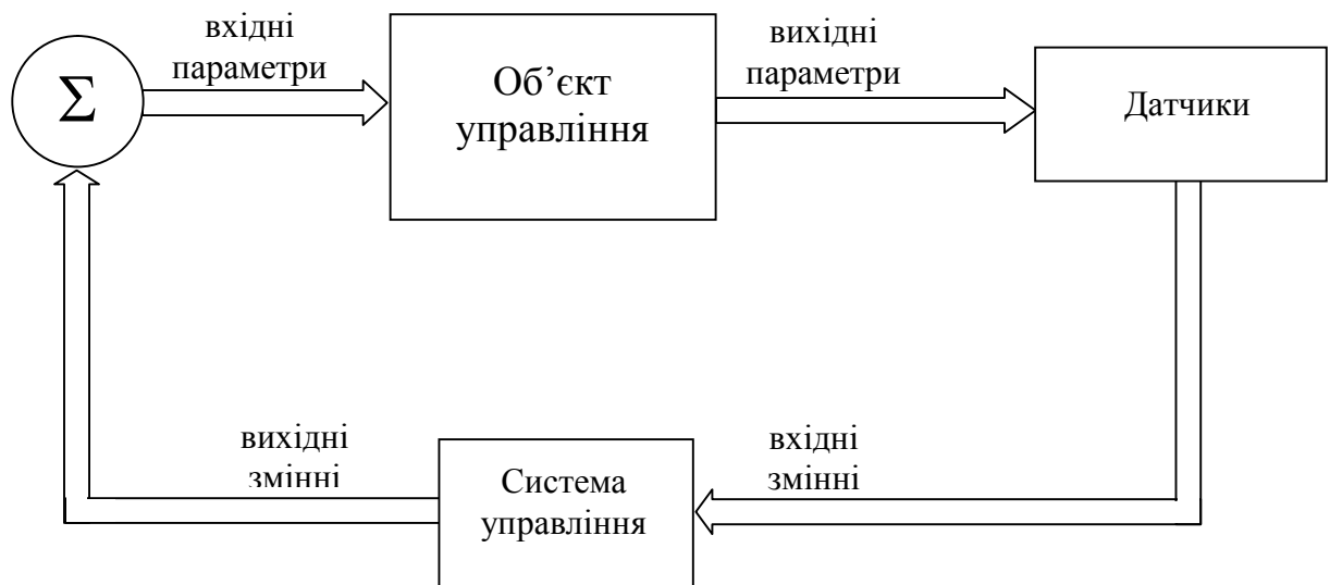
Рисунок 1.1 – Структура компонентів класичного процесу управління із зворотним зв'язком
