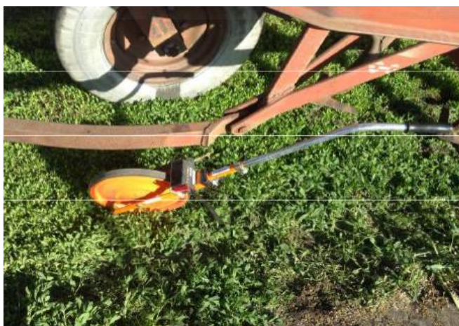
Рисунок 2.13 – колієвимірювальне («П'яте») колесо
