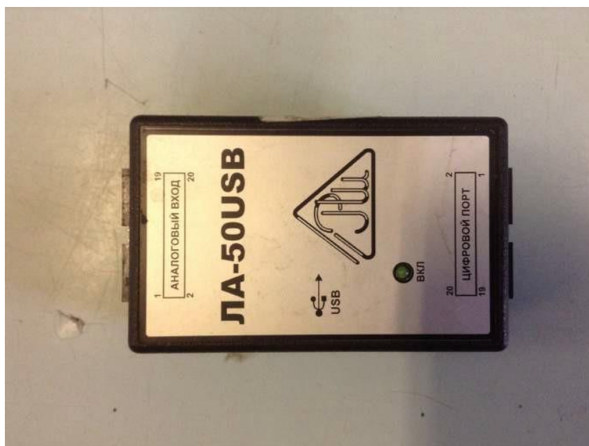
Рисунок 2.6 - Аналого-цифровий перетворювач ЛА-50 USB
