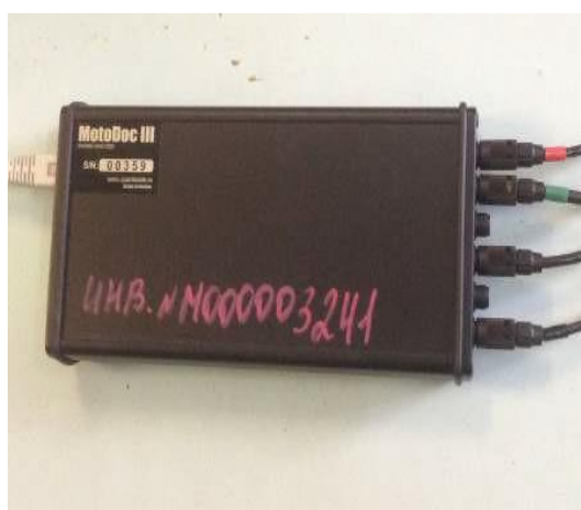
Рисунок 2.8 - Центральний (електро-ний) блок діагностичного комплексу MotoDoc III
