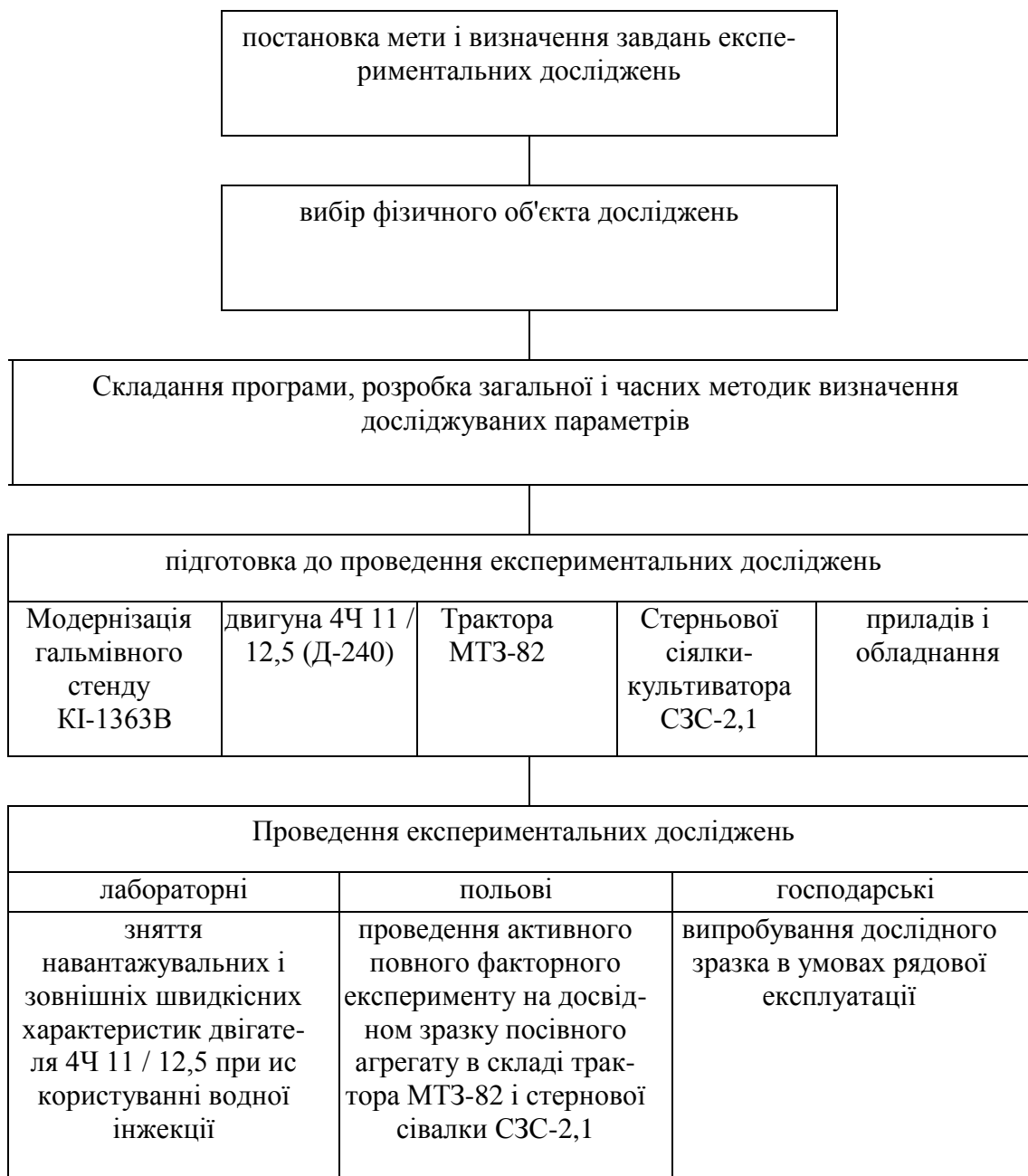
Рисунок 2.1 - Структурна схема експериментальних досліджень
