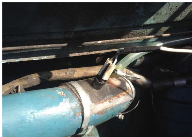
Рисунок 2.14 - Водний інжектор, встановлений на експериментальному тракторі МТЗ-82
