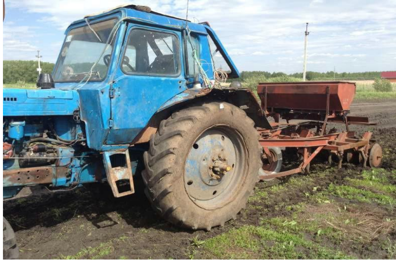
Рисунок 2.11 - Загальний вигляд експериментальної установки на базі трактора МТЗ- 82 і стерньової сівалки СЗС-2,1
