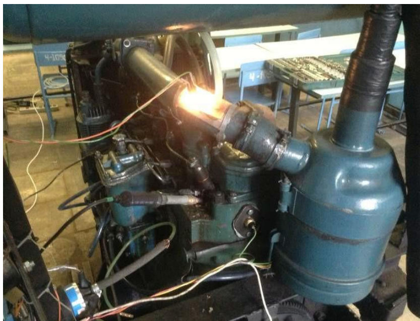
Рисунок 2.7 - Датчик тиску діагностичного комплексу MotoDoc III
