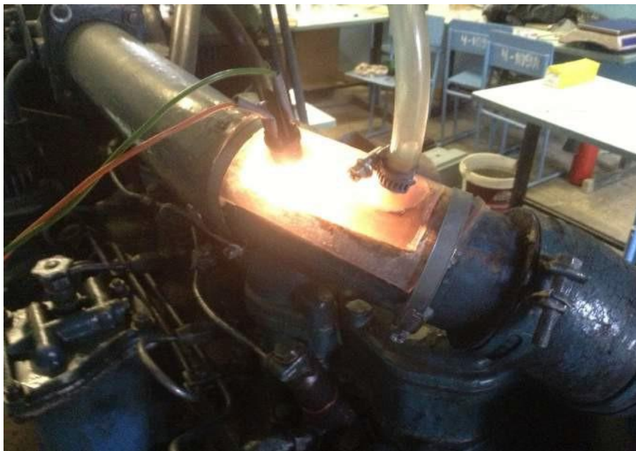
Рисунок 2.2 - Пристрій для подачі води у впускний колектор експериментального двигуна 4Ч 11/12,5
