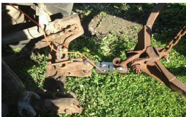
Рисунок 2.12 - Тензозвено для виміру тягового зусилля на гаку трактора
