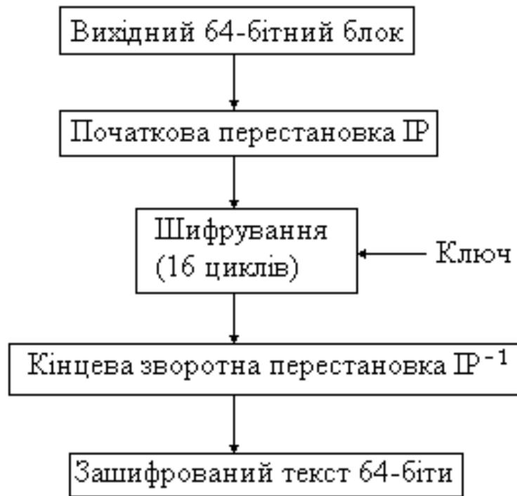
Рис 5.1 – Загальна схема алгоритму DES
