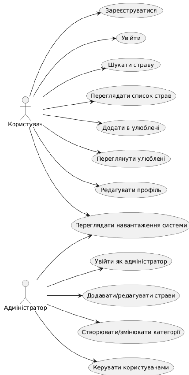
Рисунок 2.1 – Use-case діаграма ролей та сценаріїв для DishSelectorApp
