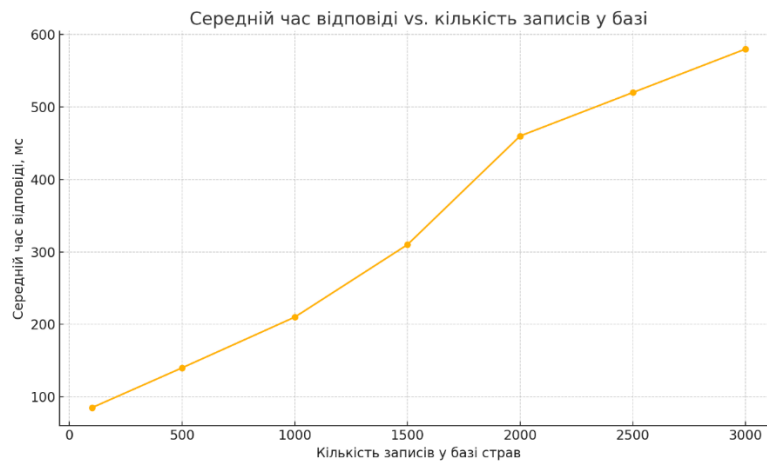
Рисунок В.3 – Порівняння продуктивності: середній час відповіді залежно від об'єму даних у базі
