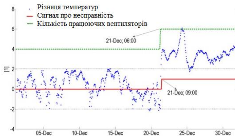
Рисунок 3.20 – Допустиме відхилення між виміряною та розрахованою температурою масла при несправній роботі вентиляторів і сигнал про несправність
