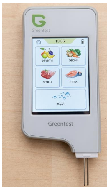
Рис. 2.2 – Нітрат-тестер Greentest 9 F3, який використовувався для визначення рівня нітратів в овочевій продукції торговельної мережі міста Харків
