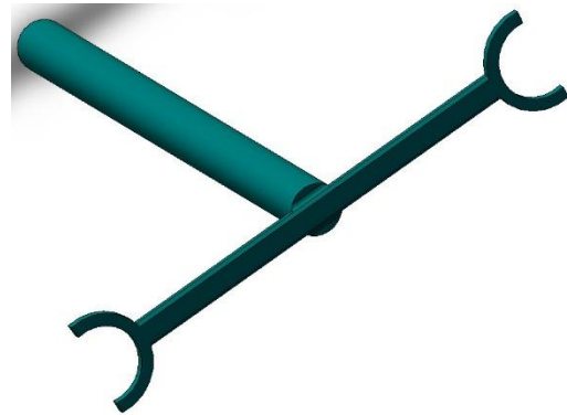
Рисунок 6.11 – Маніпулятор оброблювального центра VA 500.
