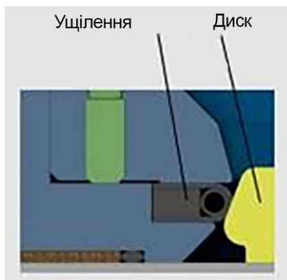
Рис. 18 - Ущільнення дискового затвора з подвійним ексцентриситетом за допомогою притискного кільця
