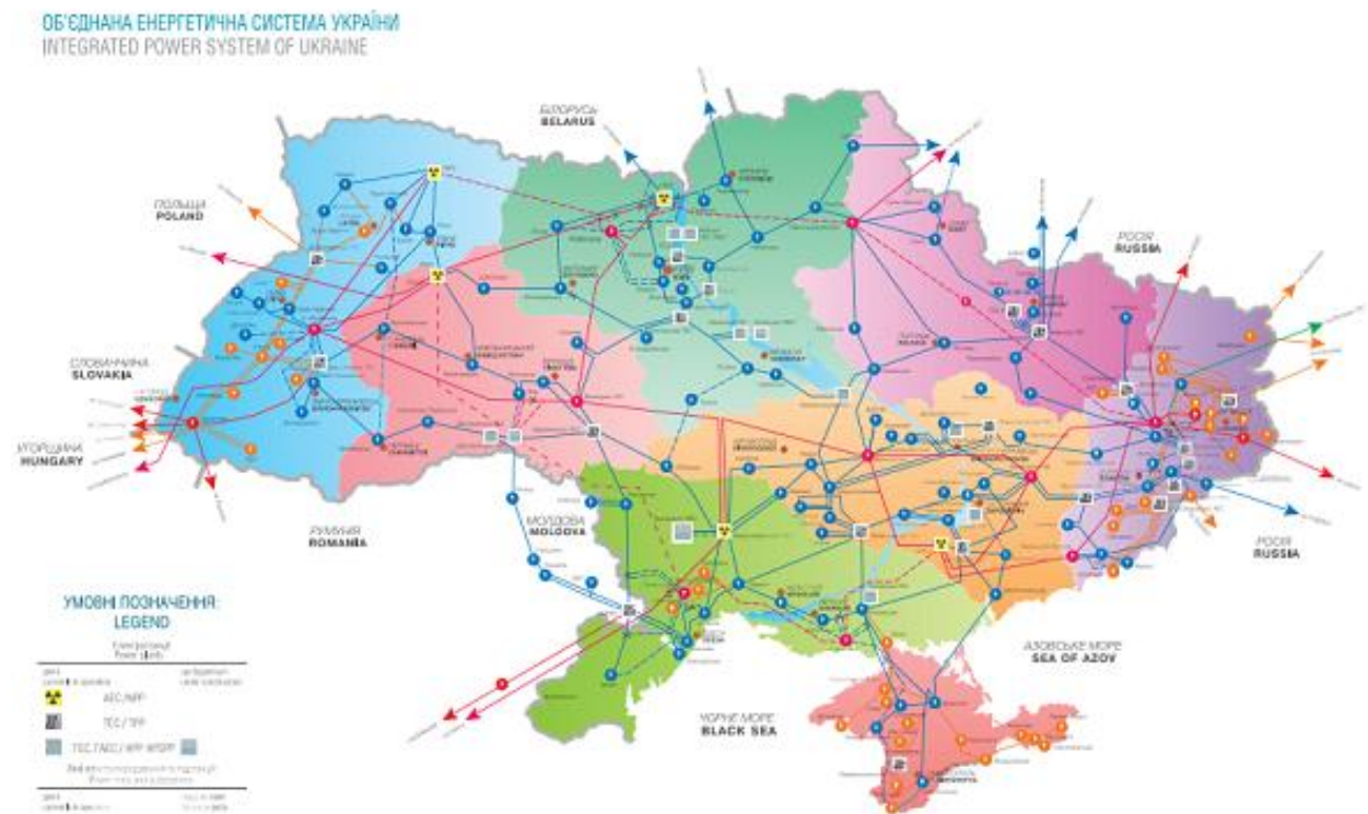
Рисунок 3.1 Структура та топологія електричних мереж об'єднаної енергосистеми України
