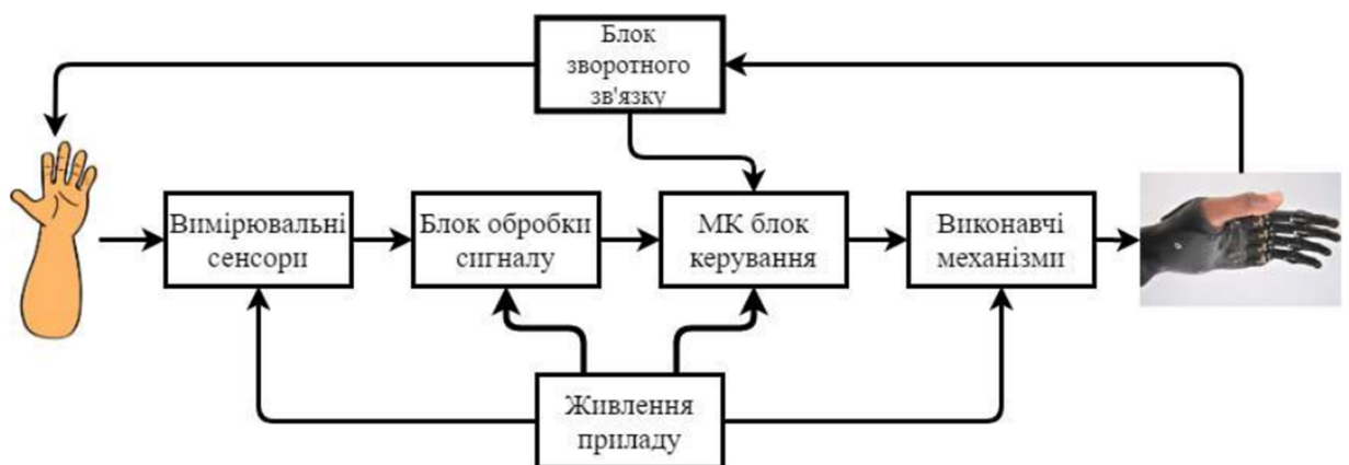
Рисунок 1.1 – Типова схема біонічної протезної системи верхньої кінцівки.
