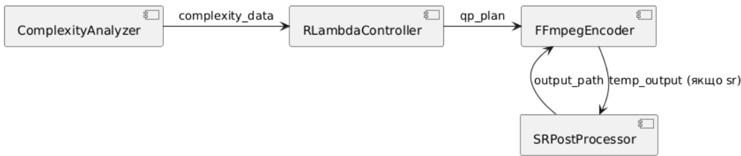
Рисунок 2.5 – Діаграма компонентів архітектури NeuroQuant
