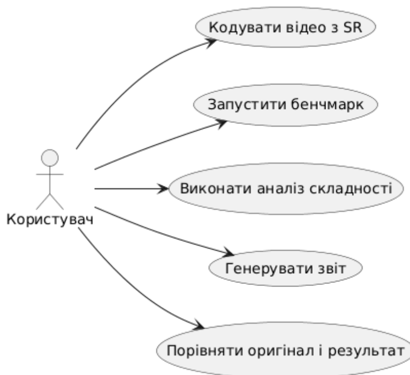
Рисунок 2.4 – Діаграма варіантів використання системи NeuroQuant
