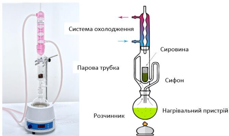
Рисунок 1.3 Апарат Сокслета та його схема.
