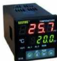
Рисунок 9 – Регулятор температури нагрівача екструдера
