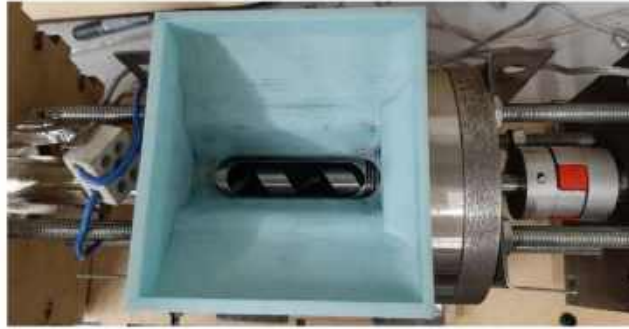
Рисунок 7 – Шнековий модуль з бункером та механізмом передачі крутного моменту на вал
