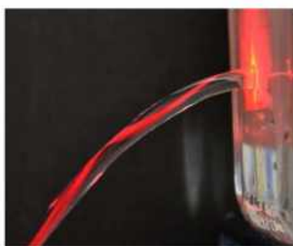
Рисунок 1 – Експеримент із відображенням світлового променя у струмені води Практичне застосування технології знайшлося лише у XX столітті. Так у
