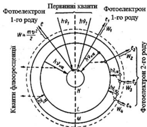
Рис. 3.1. Схема поглинання квантів рентгенівського випромінювання з випусканням характеристичного випромінювання (зліва) та випусканням електронів 2-го роду (справа) [12]
