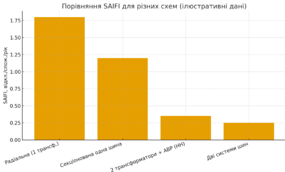
Рисунок 3.9 - Порівняння SAIFI для різних схем
