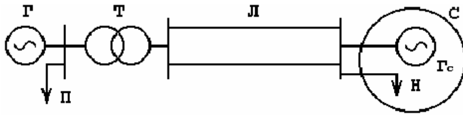
Рис. 2.12. Схема заміщення електричної системи із споживачами генераторної напруги
