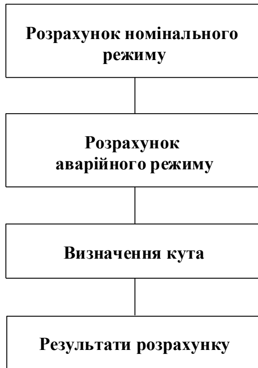
Рис. 3.8. Логічна структура комп'ютерної програми для виконання лабораторної роботи з визначення часу зміни кута \delta синхронних генераторів з різним моментом інерції під час великих зовнішніх збурень
