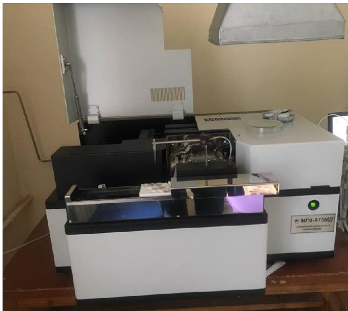
Рис. 2.1 – Зовнішній вигляд атомно-абсорбційного спектрометра МГА – 915 МД
