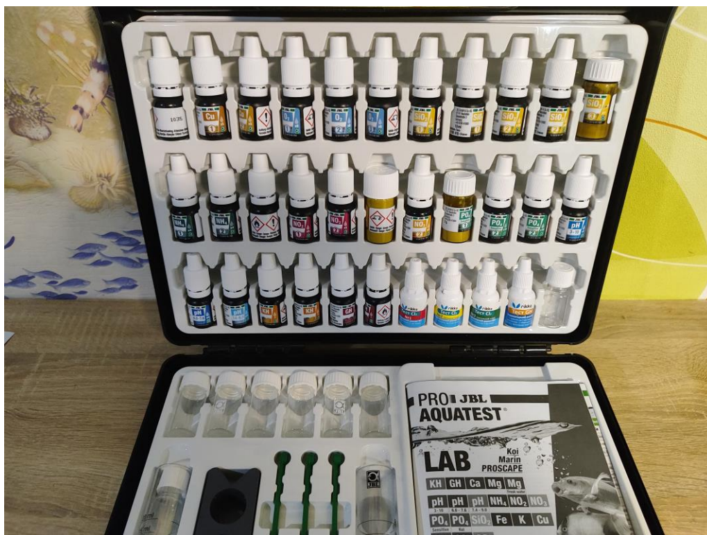
Рис. 2.2 Титрометричний набір для визначення у воді загальної жорсткості, хлору залишкового, вмісту заліза та міді
