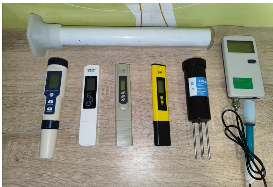
Рис. 2.1 Потенціометричні прилади для вимірювання у воді рН, засоленості, загальної мінералізації, електропровідності та нітратів і циліндр для визначення прозорості води
