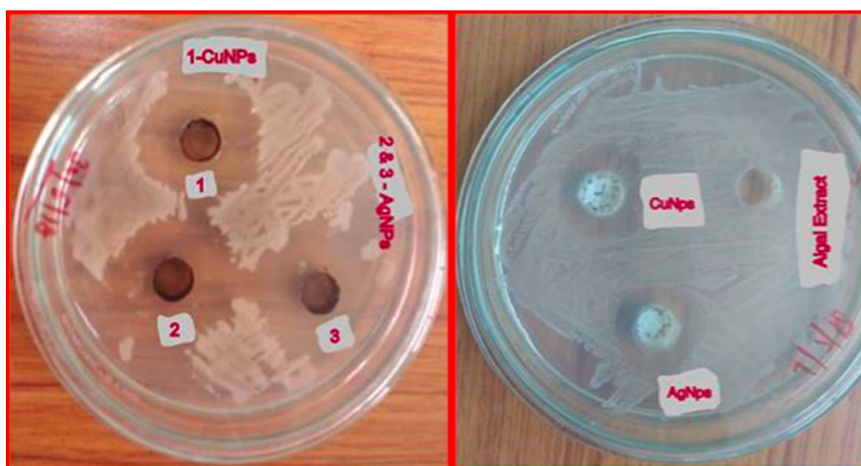
Рис. 3.12. Антибактеріальний тест, що демонструє зону пригнічення росту двох бактерій Staphylococcus aureus та Pseudomonas aeruginosa .
