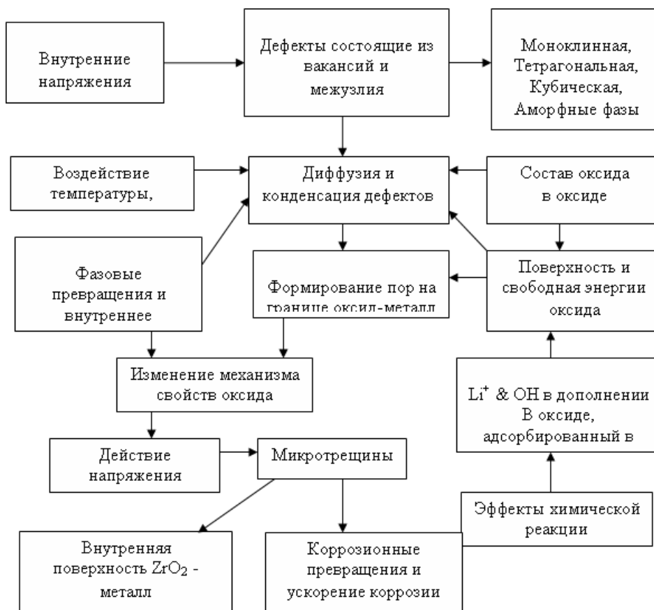
Рис. 3.110. Схема эволюции микроструктуры при коррозии сплавов циркония
