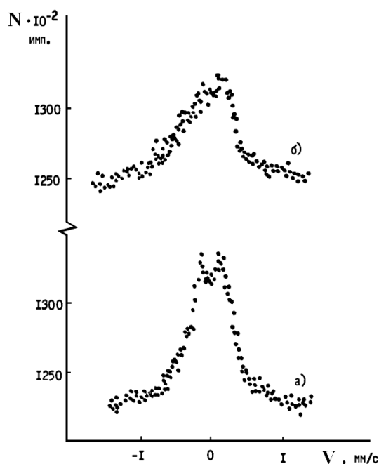
Рис. 3.87. Спектры рассеяния поверхности деформированного неотожженного сплава Zr+0,5\%Sn+0,5\%Nb+0,5\%Fe . а – необлученная сторона, б – облученная сторона
