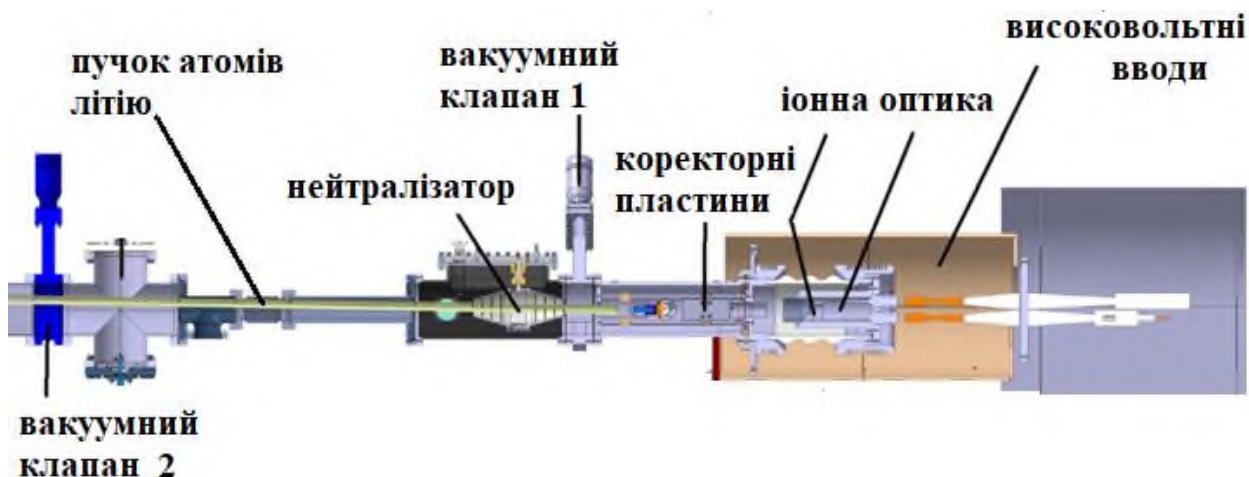
Рис. 2.3. Конструкція інжектора атомів літію діагностичного комплексу ПЕС на токамакі COMPASS.
