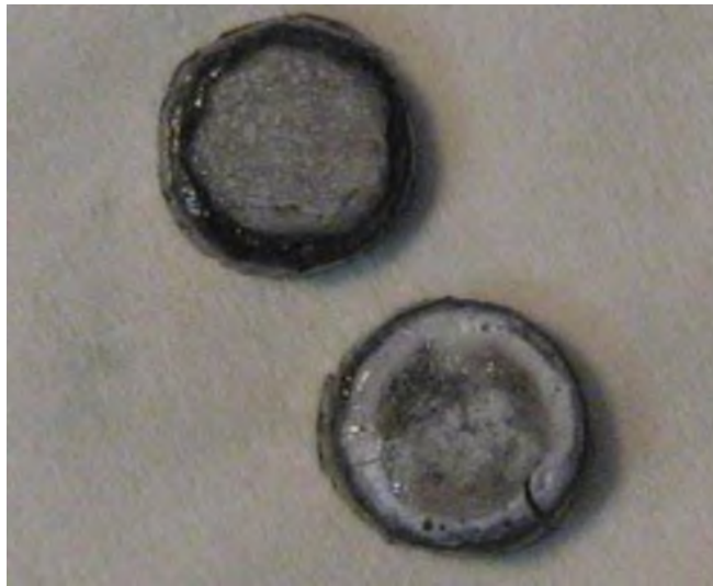
Рис. 1.4. Фото твердотільних термомітерів іонів цезію, після виготовлення (верхній) та після відбору струму іонів 0,5 мА·год (нижній): діаметр емісійної поверхні емітера 8 мм, основа емітера - танталова фольга товщиною 0,2 мм.
