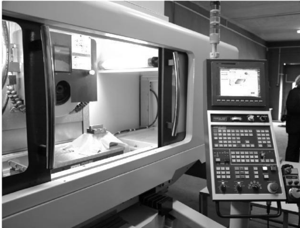
Рисунок 4.1 – Верстат із встановленим на ньому силівимірювальним комплексом Amti MC36-1000UP
