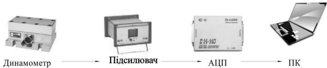
Рисунок 4.2 – Система для вимірювання складових сили різання
