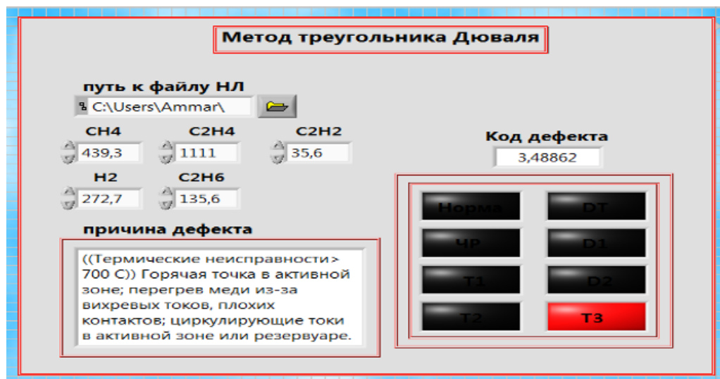
Рисунок 2.21 – Робочий інтерфейс програми, що реалізує нечітку передиктивну модель за методом трикутника Дюваля
